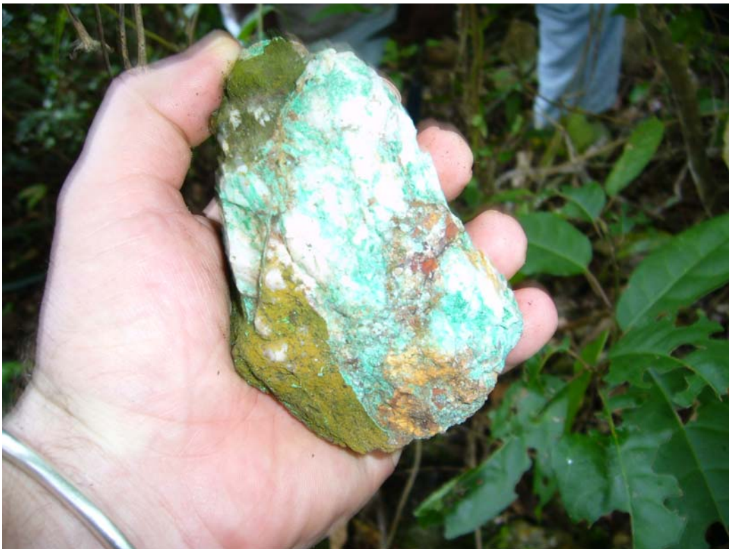
Copper mineralisation in quartz at the Grosse Veine copper-gold prospect , SOMINE copper-gold property, Haiti. / Minéralisation en cuivre sur quartz, prospect cuprifère et aurifère de la Grosse-Veine, propriété SOMINE, Haïti (source: Majescor)
